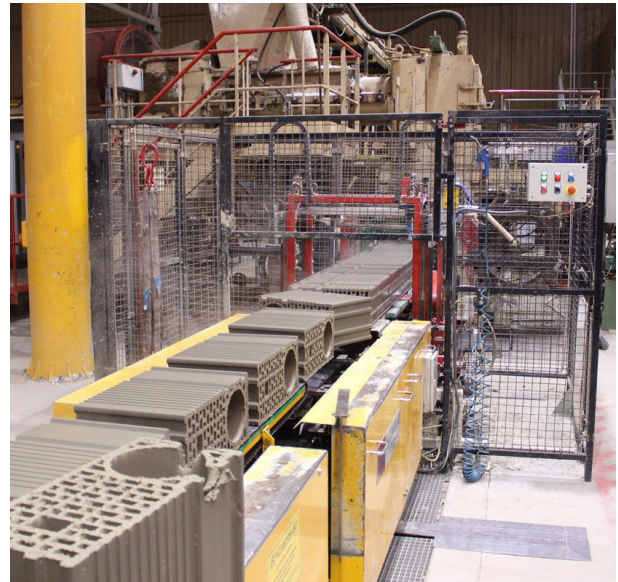
Extrusion des briques à l'usine de Pont de Vaux
